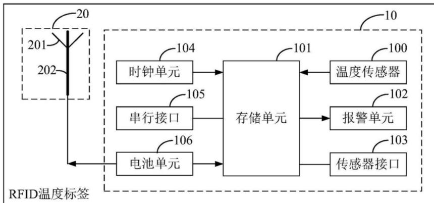
RFID温度标签芯片包括**温度传感器、存储单元和报警单元**，当疫苗温度高于预设值时，报警模块被触发进行报警。
