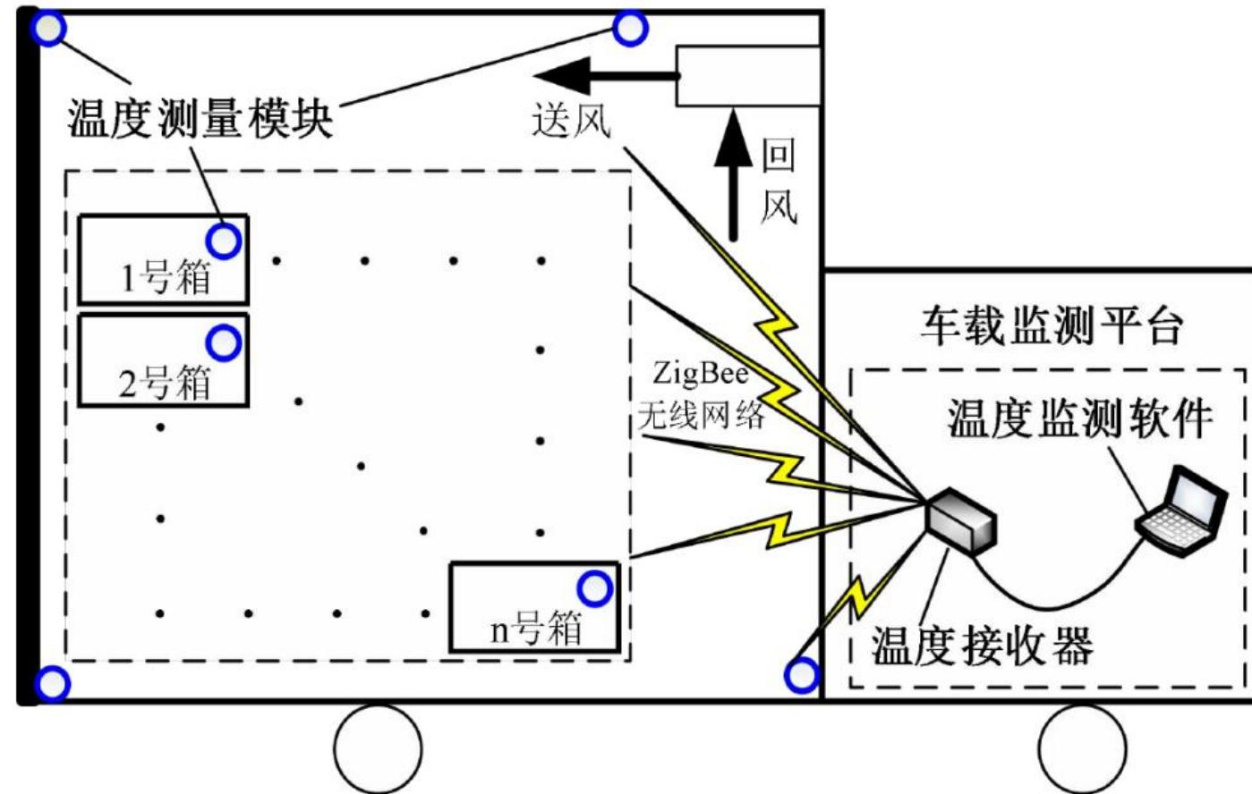
基于ZigBee技术设计的车载温度监测系统结构示意图
